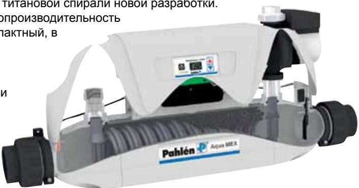
Теплообменник имеет прямой поток в контурах при низком гидравлическом сопротивлении и рассчитан для подключения труб диаметром 63 мм. Минимальный поток во вторичном контуре (бассейновая вода) составляет 90 л/мин.
